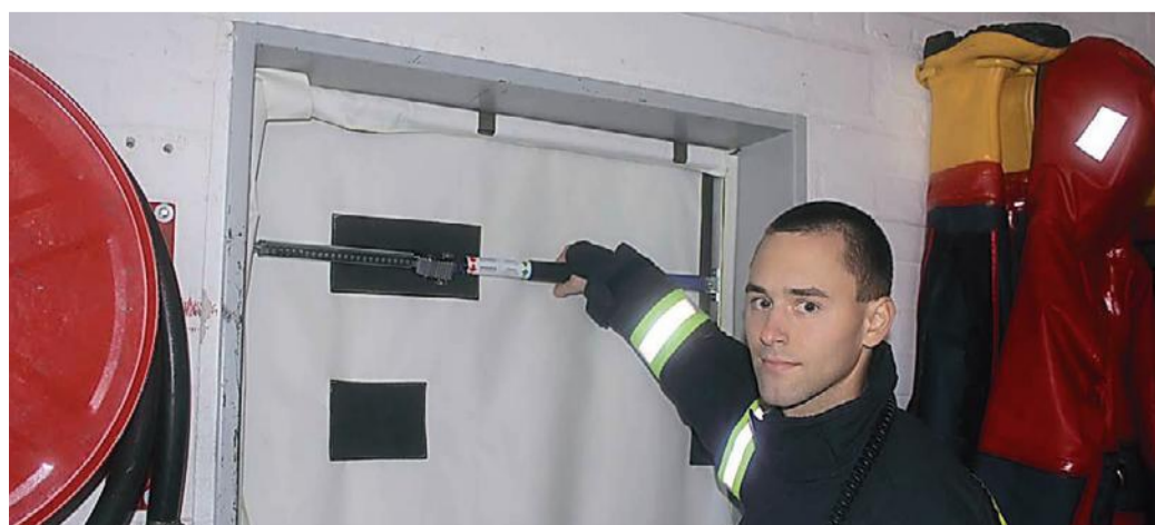
Feuerwehrmann Florian Holzapfel hat den Rauchverschluss in Windeseile montiert. Foto: Kaiser
