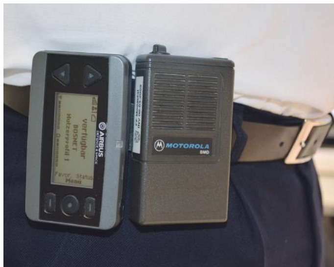
Größenvergleich Neu/Alt – Airbus P8GR (links) und Motorola BMD (rechts) in Gürteltrageweise
